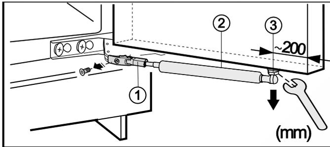
**Внимание**, амортизатор закрывания двери в демонтированном состоянии сжимается!
